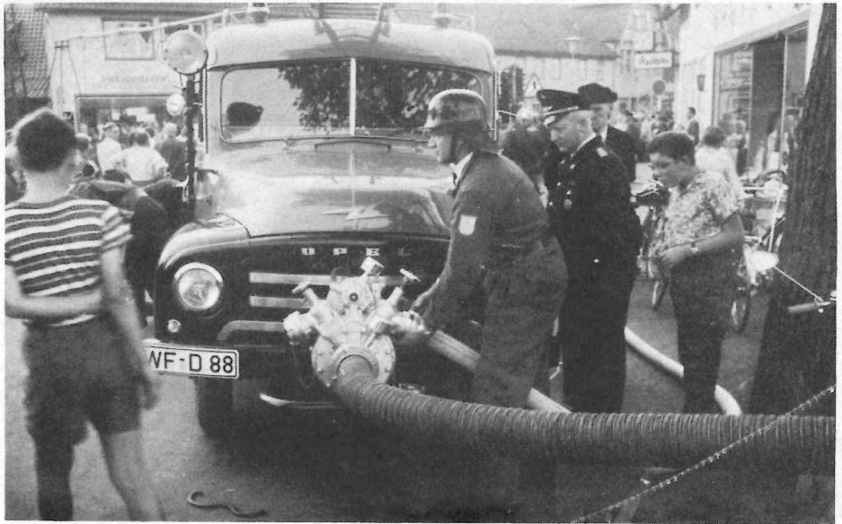
Vorbaupumpe des LF 8 im Einsatz
